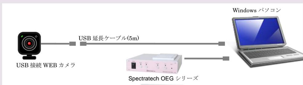
同梱品の USB 接続カメラを、同じく同梱品の USB 延長ケーブル(5m)を経由して、OEG-アプリケーションが稼働している Windows パソコンの空いている USB 端子に接続してください。当 USB カメラは Windows の標準デバイスですのでデバイスドライバのインストールは必要ありません。当カメラを USB 端子に接続すれば自動的に認識されます。
